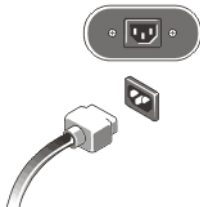
Figur 8. Tilkobling av strøm
